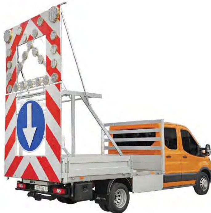
Verkehrssicherungsanhänger SPLU26A auf einem Fahrzeug montiert
