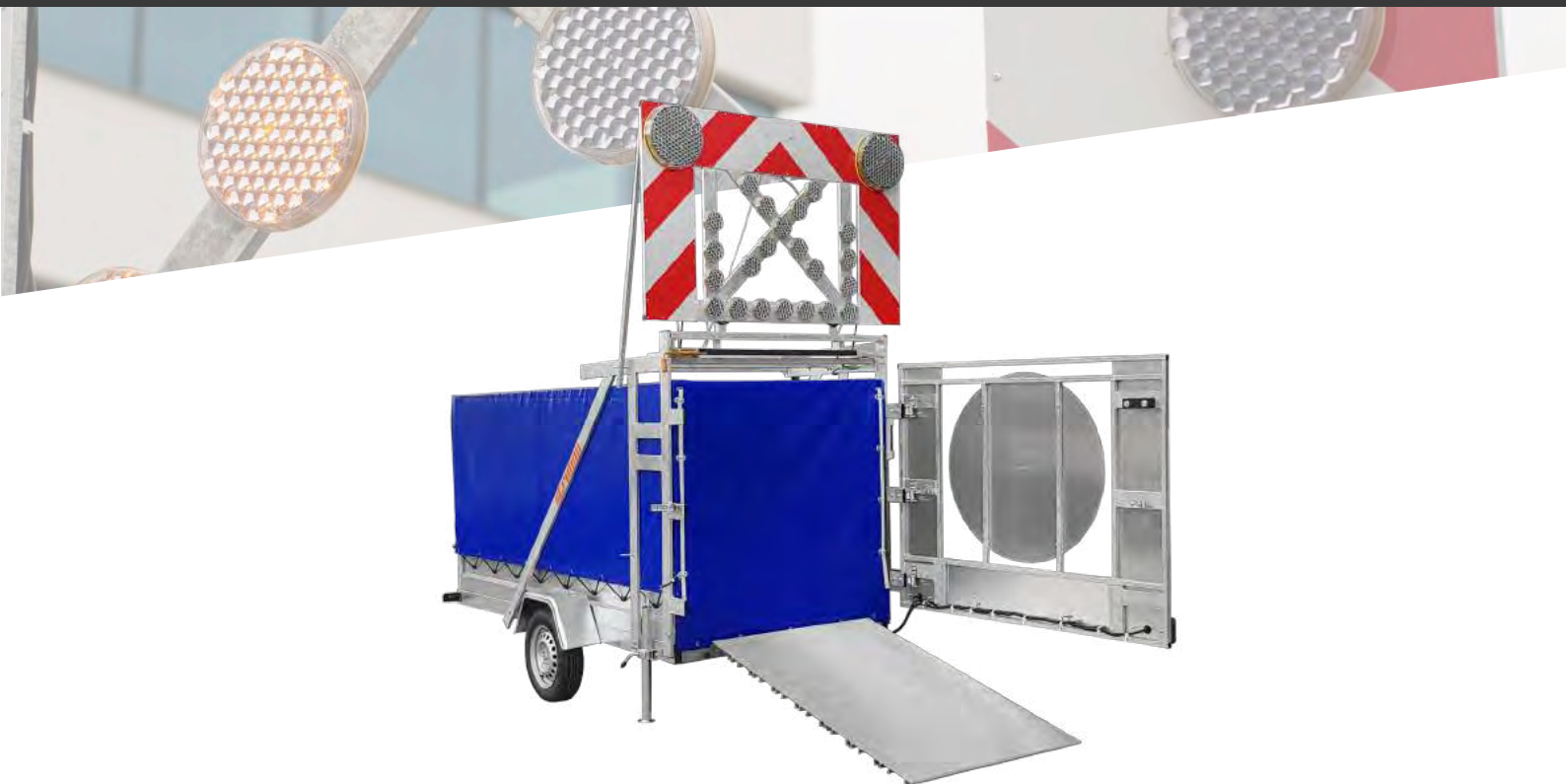
Verkehrssicherungsanhänger SPLU26C mit Plane und Laderampe
